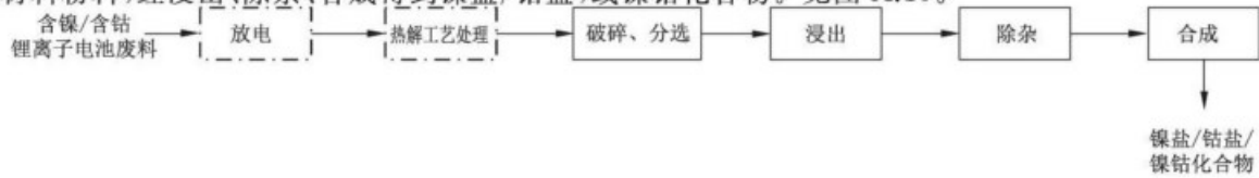
图 A.10 含镍/含钴锂离子电池废料利用工艺
