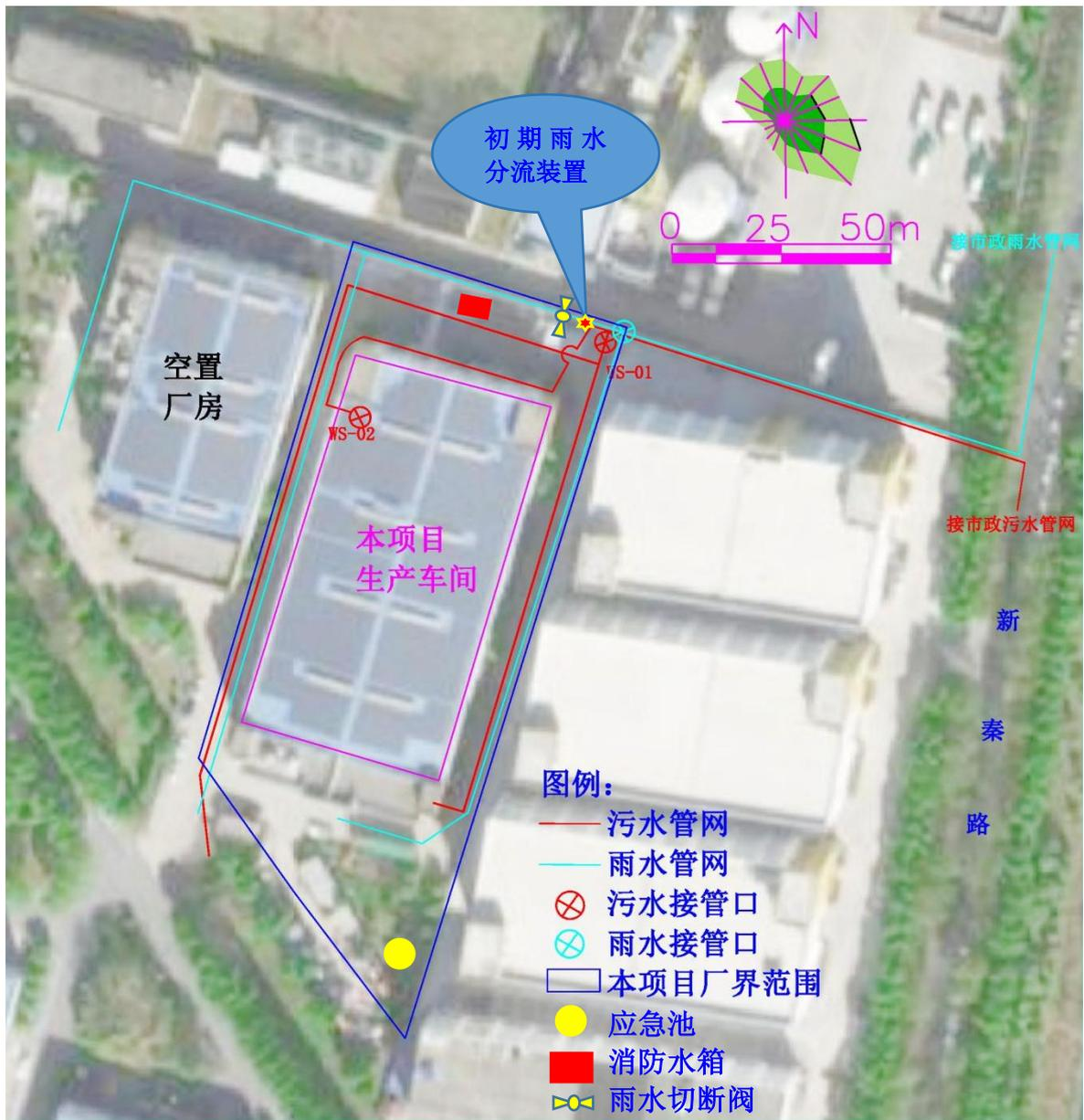
附图 9 事故水进入外环境的控制、封堵系统图
