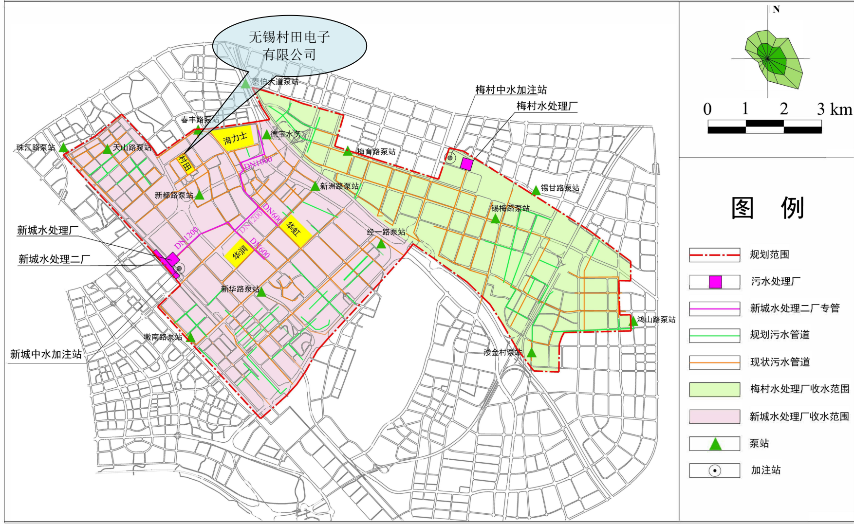
附图 9 项目所在区域污水管网图
